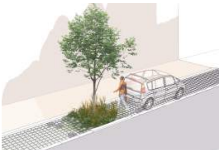
Principe du calpinage des pavés béton
